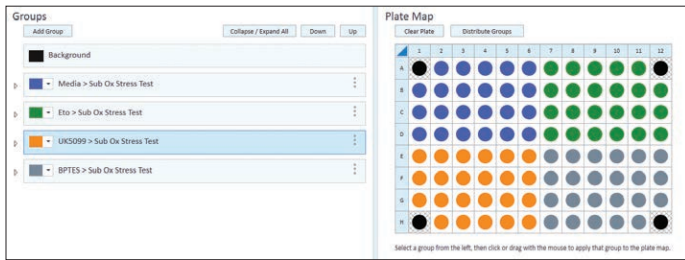
그림 4. 여러 키트/억제제를 사용한 기질 산화 스트레스 테스트용 Agilent XFe96 분석 템플릿. 그림 지정 및 대조군(포트 A에서 실험 배치 주입)을 포함해 세 가지 다른 억제제로 각 세포 유형을 테스트하기 위한 플레이트 레이아웃. 이 템플릿을 3번 반복 했으며, 세포 유형(A549, C2C12 또는 HepG2)만 변경했습니다. 기타 모든 분석 템플릿 정보 및 XF 기기 실행 명령은 분석 전반에서 동일합니다.
