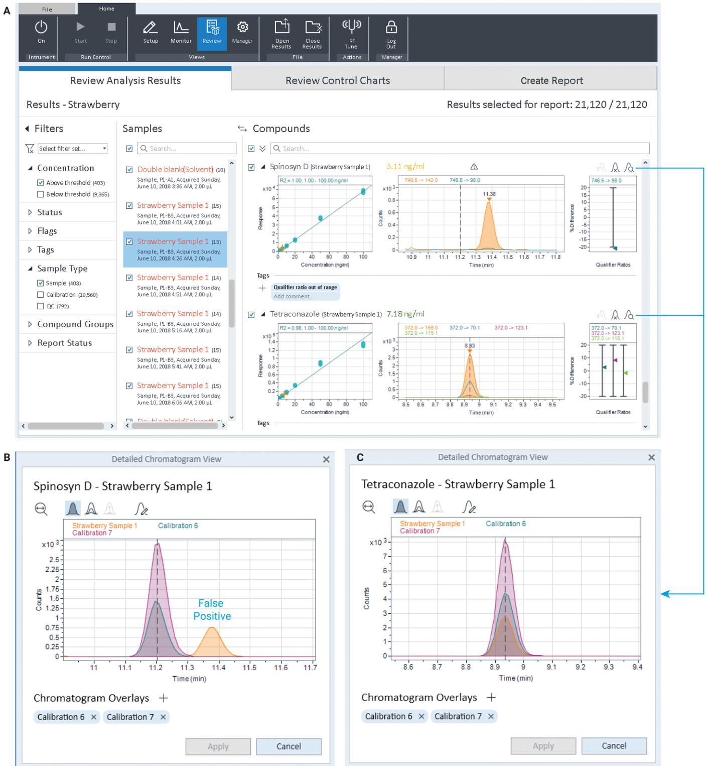
图 4. (A) 在非有机草莓样品中鉴定出的多杀菌素 D 和氟醚唑。(B, C) 非有机草莓和两个校准样品中鉴定出的农药的定量离子叠加图。(B) 与两个校准样品相比, 非有机草莓中多杀菌素 D 定量离子的 RT 不正确 (假阳性鉴定)。(C) 校准样品和非有机草莓样品中氟醚唑的 RT 一致 (真实鉴定)
