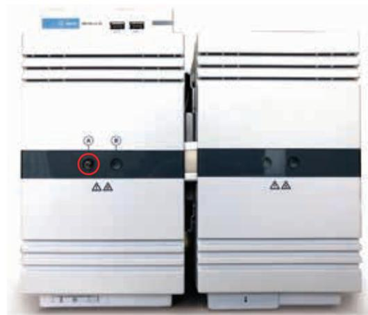
Figura 1B. Analísador NGA de três canais. O círculo vermelho indica o injetor da amostra.
