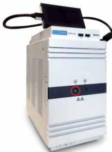
Figura 1A. Analísador NGA de dois canais. O círculo vermelho indica o injetor da amostra.
