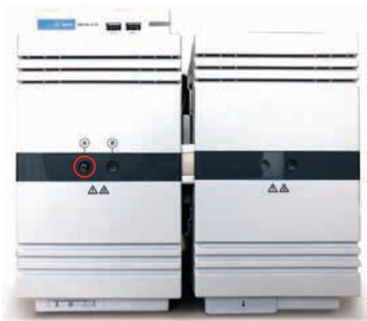
**Figura 1B.** Analizzatore di gas naturale a tre canali. Il cerchio rosso indica l'ingresso del campione.
