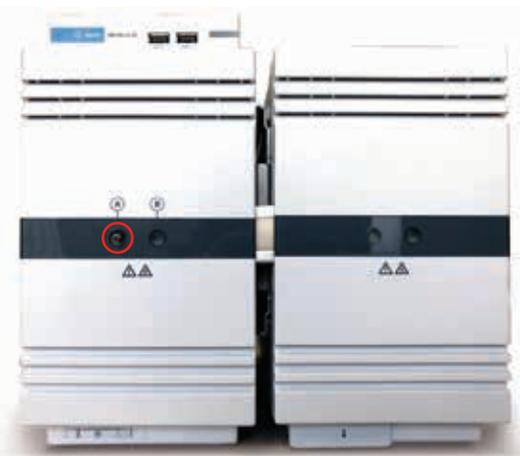
Figure 1B. Analyseur de gaz naturel à trois voies. Le cercle rouge indique l'injecteur d'échantillon.
