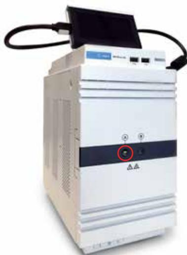
Figure 1A. Analyseur de gaz naturel à deux voies. Le cercle rouge indique l'injecteur d'échantillon.
