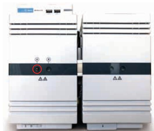
Abbildung 1B. 3-Kanal-NGA-Analyzer. Der rote Kreis zeigt den Probeneinlass an.
