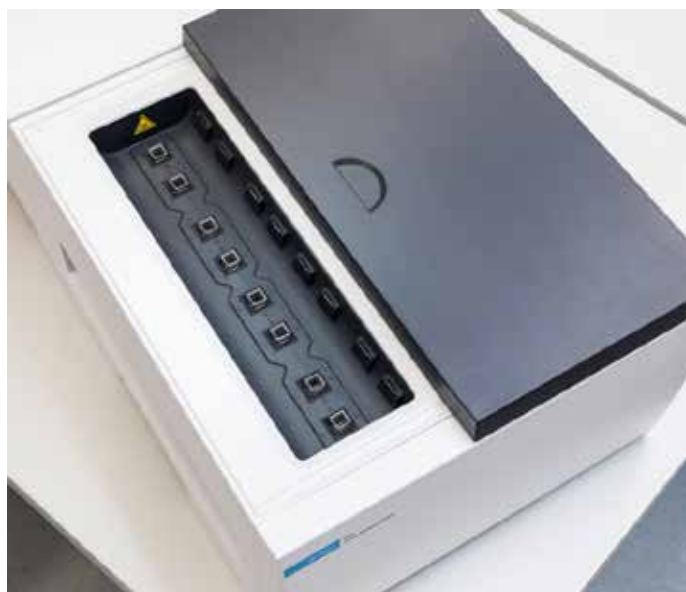
Figura 1. Il vano per i campioni dello spettrofotometro UV-Vis Multizone Cary 3500 è dotato di un supporto multicella integrato. Ogni coppia campione/ riferimento può essere mantenuta a una temperatura diversa.
