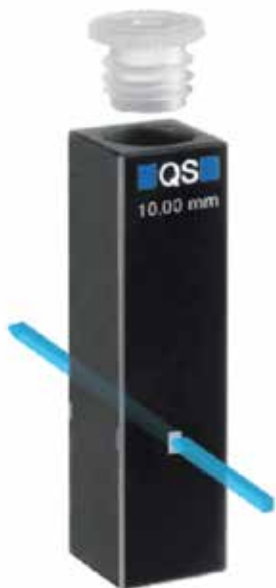
Figura 1. Il sistema UV-Vis Cary 3500 ha un fascio altamente focalizzato di ampiezza inferiore a 1,5 mm. Grazie al fascio di piccole dimensioni, il sistema è ideale per l'utilizzo con cuvette dotate di piccole aperture, come quella mostrata qui.
