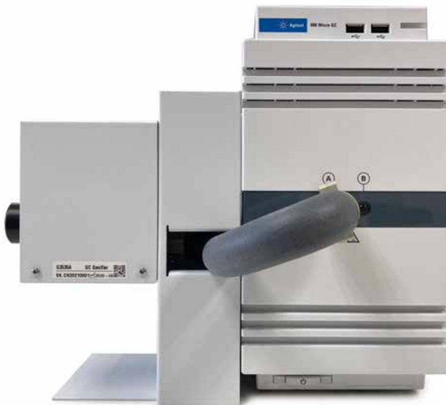
Figura 1. Gasificador de GC G3535A de Agilent instalado en el sistema Micro GC Agilent 990.
