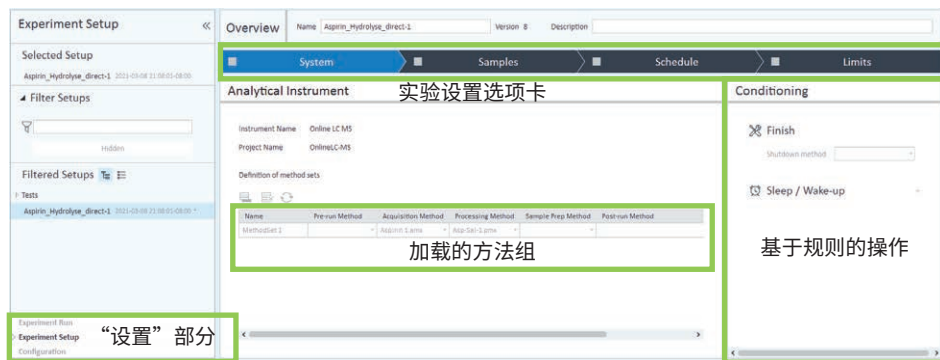
图 2. 安捷伦在线液相色谱监测软件中的实验设置，显示了系统设置。可选择方法并组合成方法组。可定义基于规则的操作以及样品前处理方法
