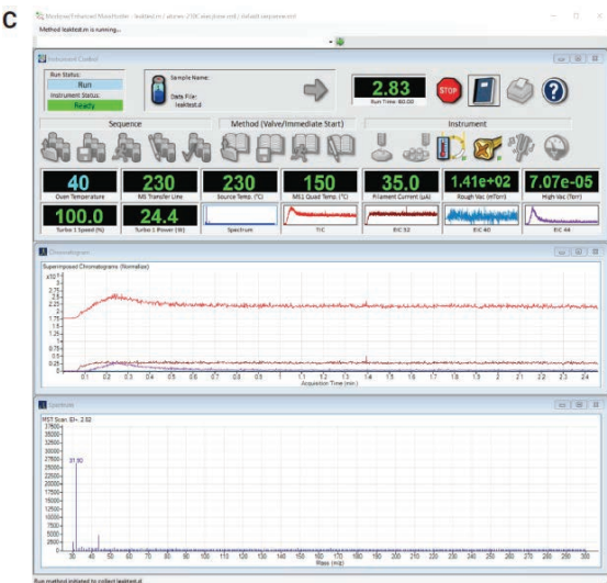
图 7. 新型检漏工具，能够监测用户指定的离子，识别泄漏源和泄漏量
