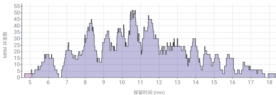
图 2. 614 个 MRM 离子对的分布，在分析过程中监测多达 52 个并发 MRMs，可实现更高效的驻留时间分布
