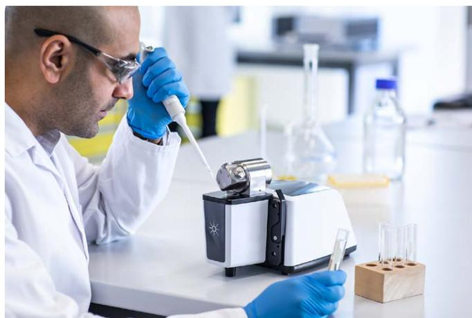
图 2. 将液体样品置于 Agilent Cary 630 FTIR 配备 Agilent DialPath 附件的样品观测窗片上
