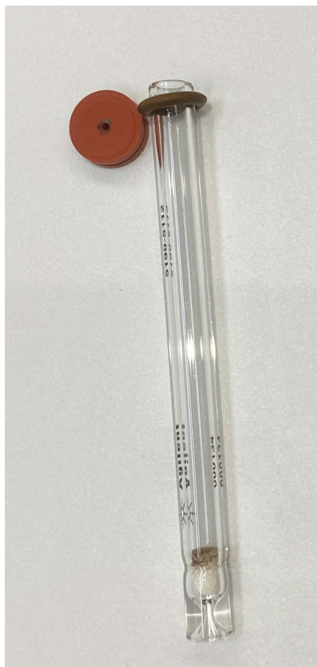
图 10. 对含有 DCM 和甲醇提取物的案件样品进行 700 次进样后的安捷伦 UI 不分流衬管（部件号 5190-5112）。所示的安捷伦预穿孔进样口隔垫（部件号 5183-4757）经历了约 300-350 次进样
