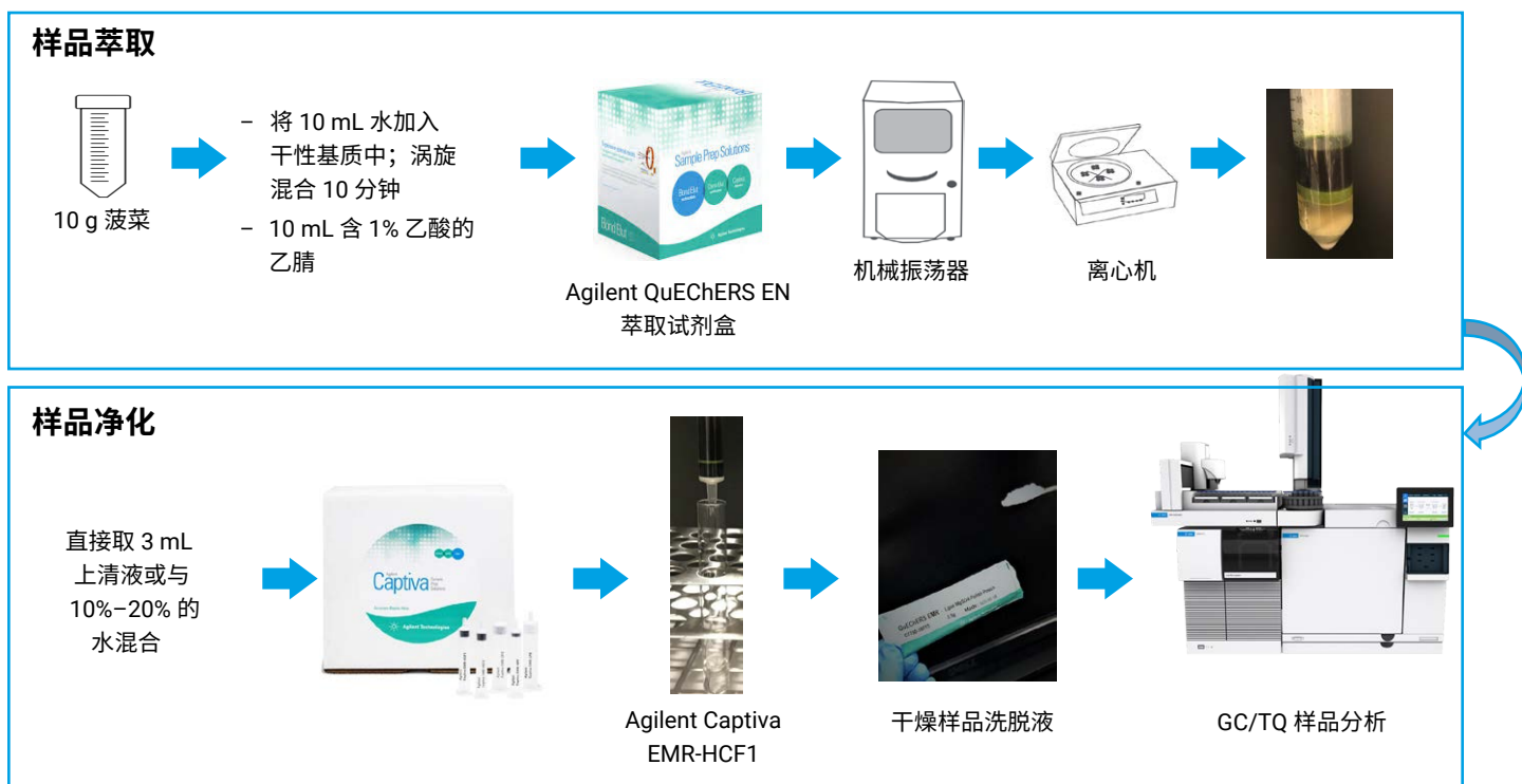
图 2. 样品前处理流程图, 包括传统的 Agilent QuEChERS 萃取以及后续的 Agilent Captiva EMR 通过式净化
