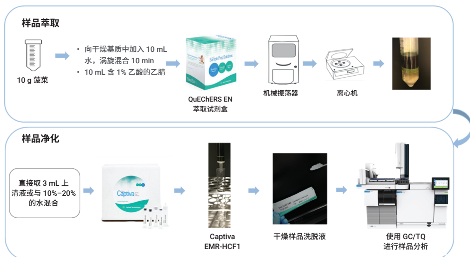
图 3. 样品前处理流程图，包括传统的 Agilent QuEChERS 萃取以及后续的 Agilent Captiva EMR 直通式净化
