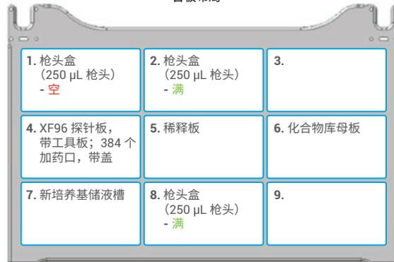
图 4. 用于连续稀释的 Bravo 台板配置和实验室器皿
