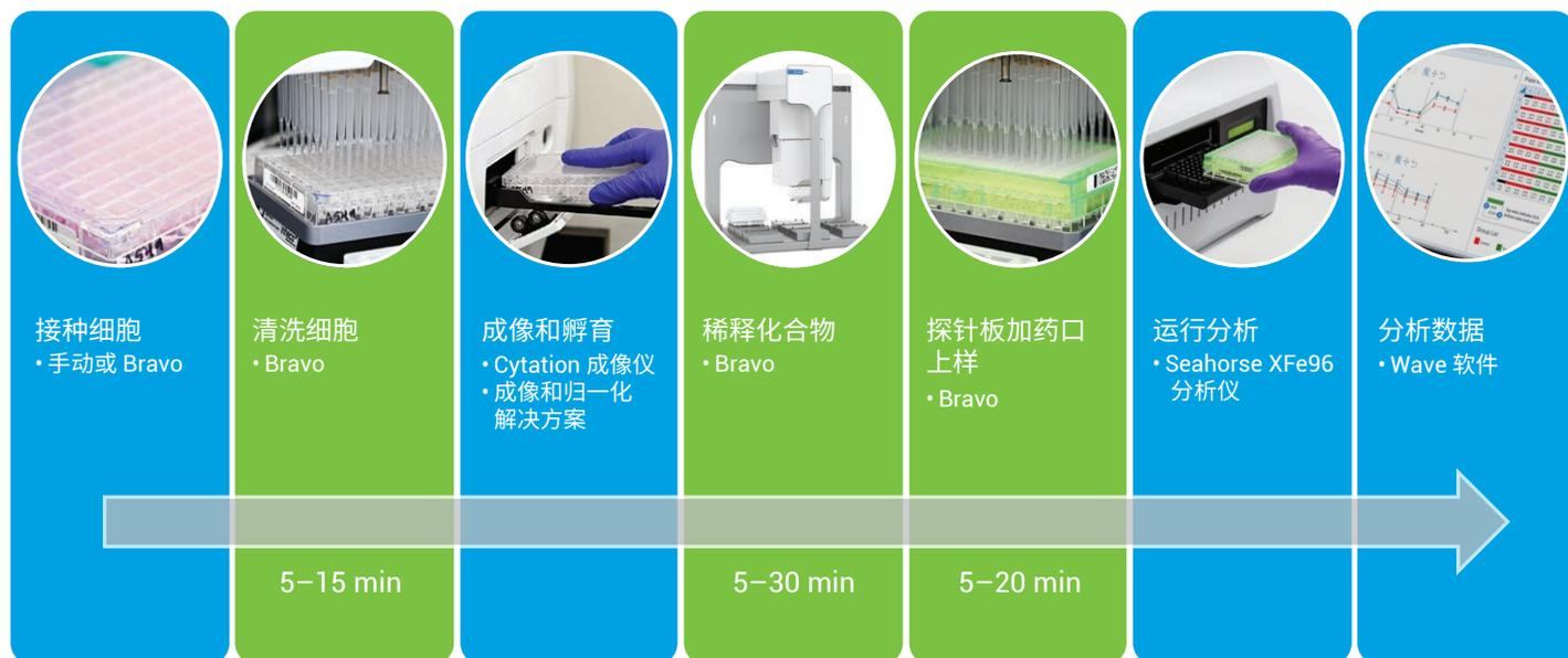
图 5. Seahorse XF 分析的一般工作流程。用 Bravo 实现自动化的样品前处理步骤用绿色表示: 清洗细胞、加样溶液的配制和 Seahorse XFe96 探针板上样。每板可节省 20-60 分钟的手动操作时间
