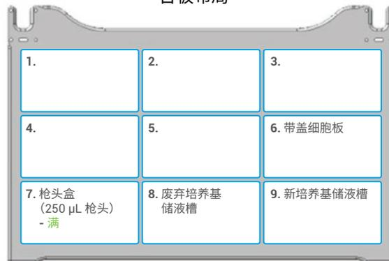
图 2. 用于细胞清洗的 Bravo 台板配置和实验室器皿
