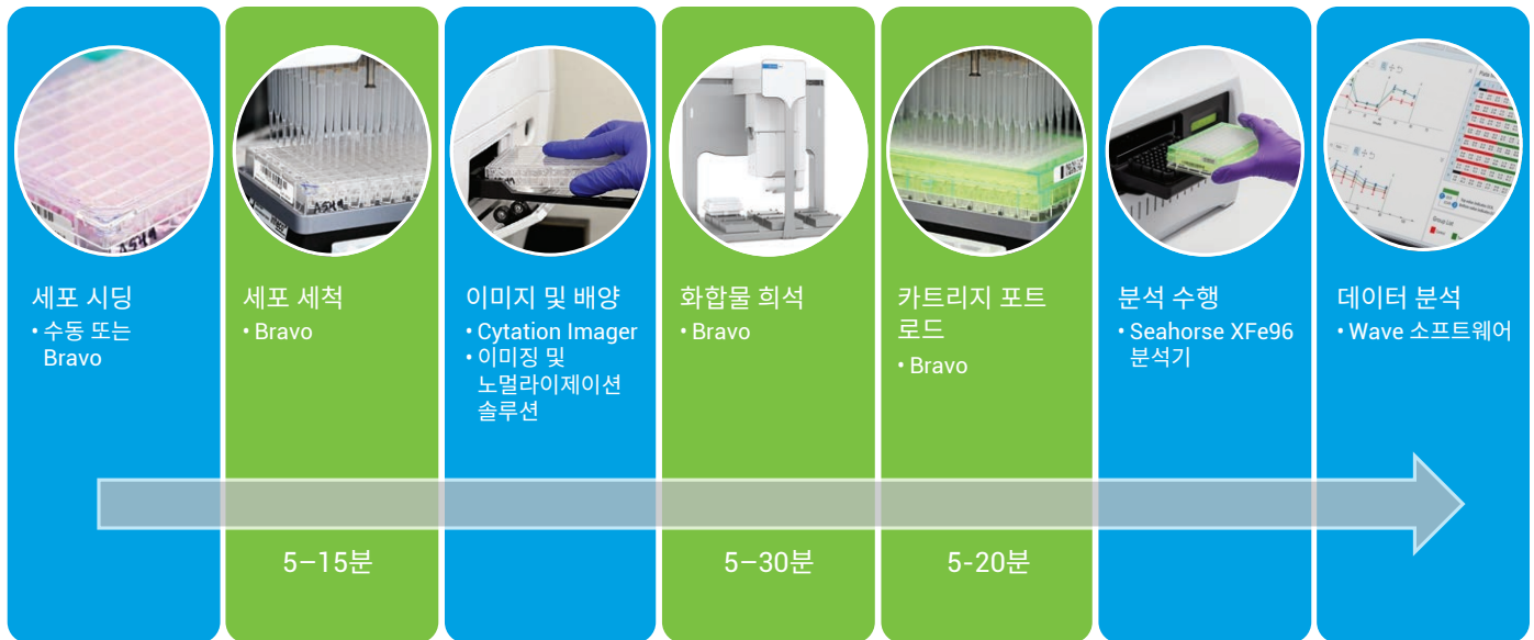
그림 5. 일반적인 Seahorse XF 분석 워크플로. 세포 세척, 주입 용액 제조, Seahorse XFe96 센서 카트리지 로딩 등 Bravo를 이용한 자동 시료 제조 단계는 녹색으로 표시됨. 플레이트당 총 수작업 시간을 20~60분 절감
