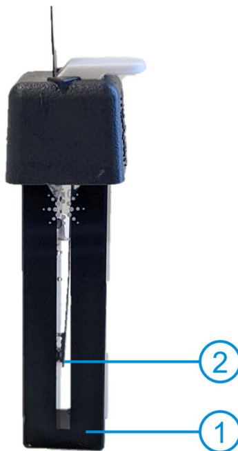
图 2. 安捷伦半微量池 (1) 和比色皿内温度探头 (2) 用于在测量过程中控制实验温度
