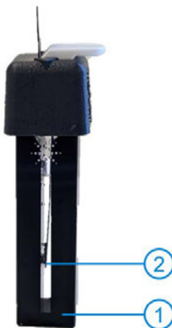
Figura 2. Celda semimicro de Agilent (1) y sonda de temperatura en la cubeta (2) utilizadas para controlar la temperatura del experimento durante las medidas.
