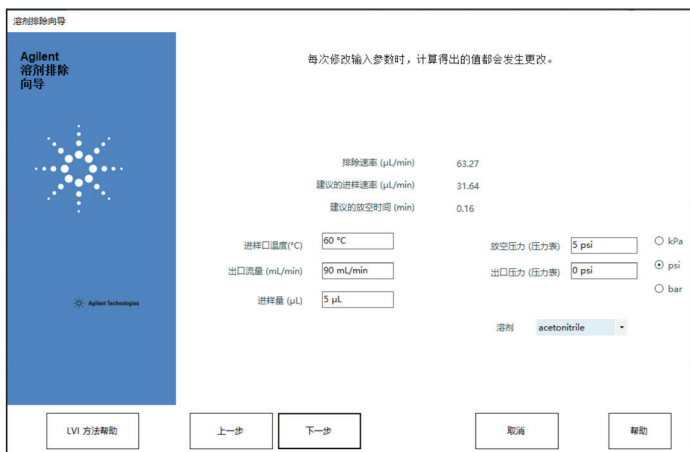
图 3. 计算器根据所选进样口温度和放空流速计算进样速率和放空时间
