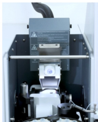
图 1. 集成观察镜的石墨炉排风系统
