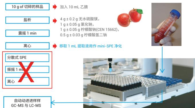
图4. mini-SPE 净化工作流程
