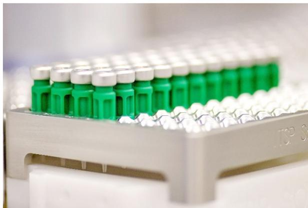
图3. mini-SPE 净化小柱
