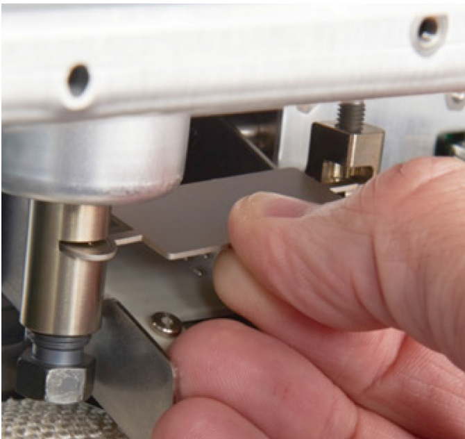
图 2. 更换保护芯片示意图
