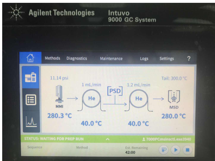
图 2. Intuvo 9000 自动配置流路
