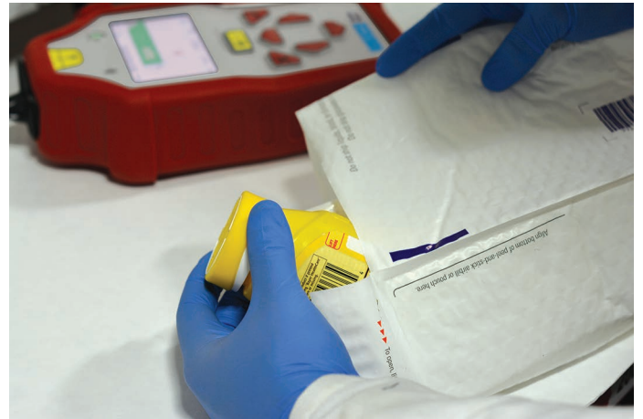
그림 1. 애질런트 Resolve 시스템은 불투명한 다층 포장재를 투과해 알려지지 않은 시료를 식별하는 독보적인 성능을 보유하고 있습니다. 이 예는 불투명한 플라스틱과 우편 포장재 내의 알약으로 구성되어 있습니다
