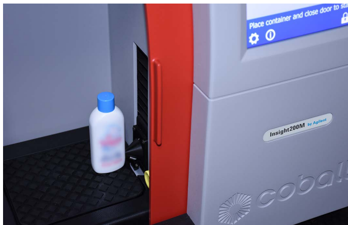
그림 3. Insight200M 시스템을 이용한 100mL 용기 스크리닝
