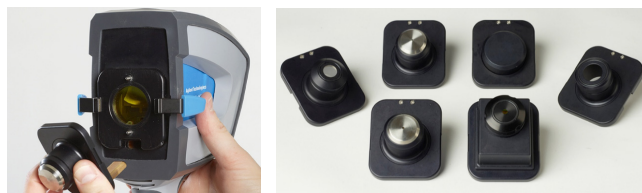
图 2. Cary 4300 手持式 FTIR 可灵活更换的采样探头
