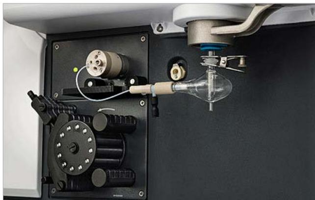
图 1. 配备安捷伦高级阀系统 (AVS 4) 四通切换阀的 Agilent 4210 MP-AES
