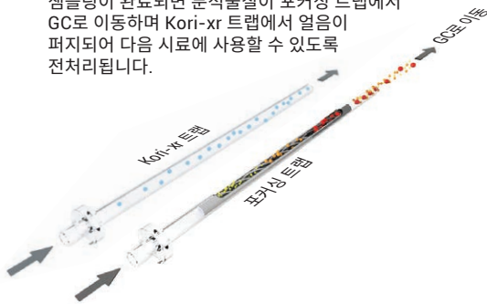
그림 2. 습윤 공기 스트림 중의 수분을 제거하는 Kori-xr 장치의 작동
