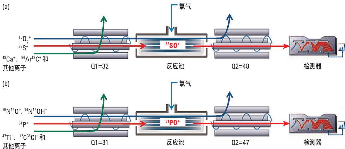
图 2. 8800/8900 ICP-MS/MS 在 MS/MS 质量转移模式下操作可消除硫 (图 a) 和磷 (图 b) 所受到的质谱干扰
