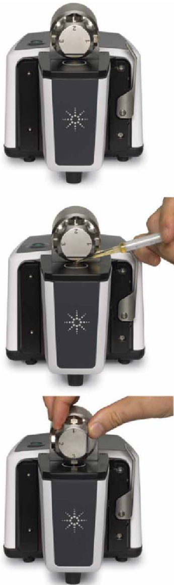
図 2. 液体サンプルの分析手順。DialPath アタッチメントを用いた 3 ステップ分析
