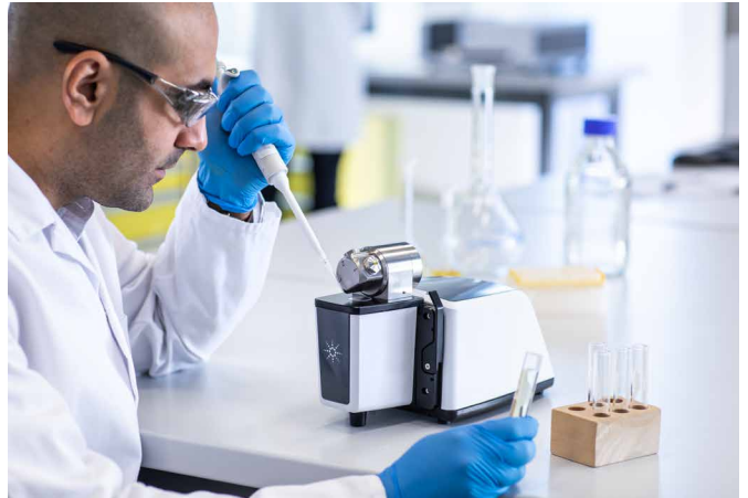
図 3. アジレント独自の DialPath サンプリングアタッチメントを装着した Agilent Cary 630 FTIR 分光光度計。Cary 630 は、超コンパクトで使いやすい高性能 FTIR 分光光度計です。DialPath 技術との組み合わせにより、液体分析において優れた性能を発揮します。
