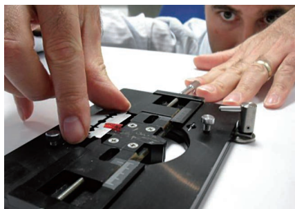
第三步：使用刀片制作样品截面
