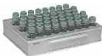
Plateau à échantillons amovible Archon, 51 positions
