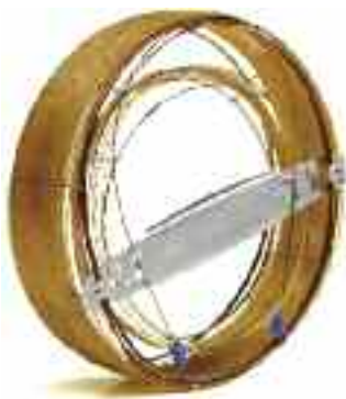
Colonne Select pour gaz permanents/CO 2 , CP7429
