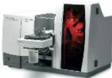
Spectromètre d'absorption atomique 280Z à four graphite
