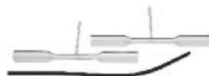
Cellules d'absorption pour les hydrures, quartz, 9910040000
