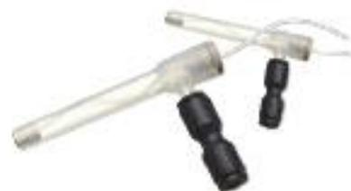
Le nébuliseur OneNeb est un modèle universel, à haute efficacité et inerte. Il est virtuellement indestructible et il s'avère extrêmement tolérant aux teneurs élevées en solides dissous ainsi qu'à la plupart des matrices d'échantillons analysés par ICP-OES et MP-AES, y compris celles fortement acides, les digestions HF et les solvants organiques. Il remplace l'habituel nébuliseur concentrique en verre et est compatible avec la plupart des chambres de nébulisation cycloniques classiques.
