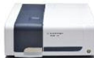
Cary 60, spectrophotomètre UV-visible
